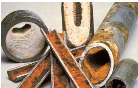
Conséquences d'un réseau de chauffage emboué
